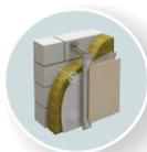
Наружные стены: Газоблок - 200 мм, утеплитель -
